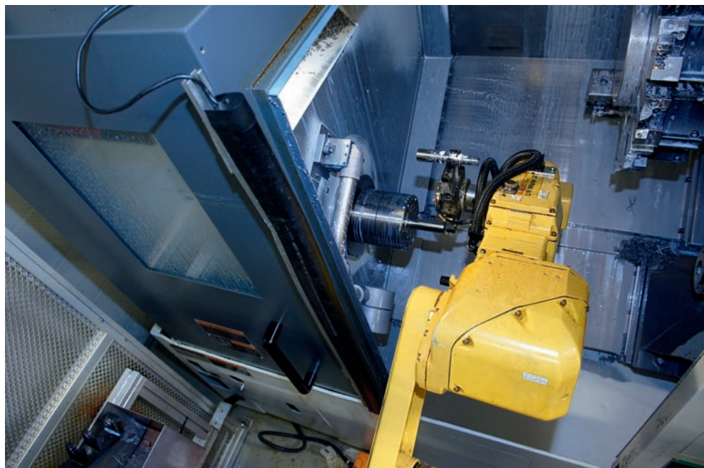
1 Automatisiertes Werkstückhandling an einem CNC-Stangendrehautomaten – seine Erfahrungen gibt Geiger fortan als Systemhaus an andere Anwender weiter
