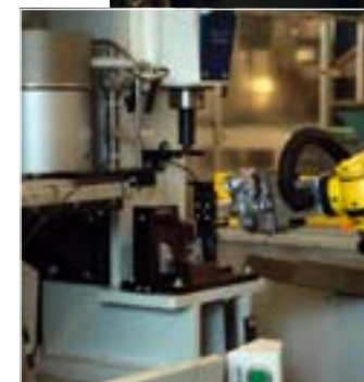
Die elektrischen Servopresse presst einen zylinderförmigen Stopfen in fertigungsbedingte Hilfsbohrungen (links)
