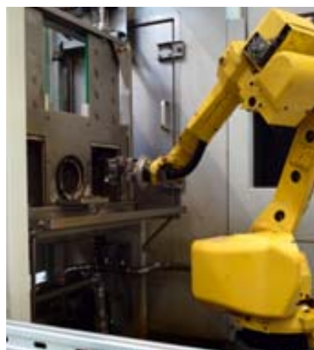
Nach der zerspanenden Bearbeitung folgt zunächst das Hochdruck-Entgraten mit Wasser oder Schneidöl
