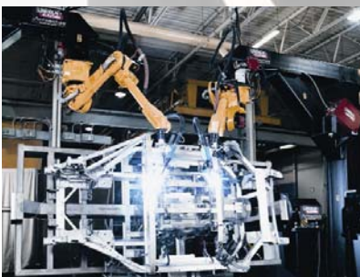
IN WELDPRO ERZEUGTE SCHWEISSPROGRAMME LASSEN SICH DIREKT IN DIE ROBOTERSTEUERUNG ÜBERNEHMEN. BILDQUELLE: LINCOLN ELECTRIC
