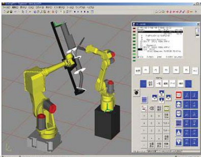
OB FORD GT ODER EINKAUFSWAGEN: MIT WELDPRO LASSEN SICH SCHWEISSAUFGABEN MODELLIEREN, PROGRAMMIEREN UND SIMULIEREN.
