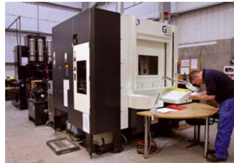
Überprüfung von Tannenbaum- und Fußflächenprofil, das auf dem I-Grinder G5 von Makino unter Nutzung des Viper-Verfahrens geschliffen wurde
