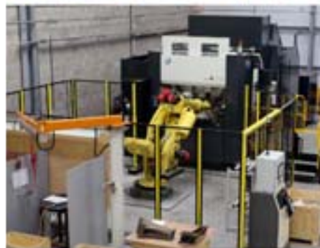
Aufgespannte Werkstücke werden per Roboter von einer Offline-Aufspannstation in den Bearbeitungsbereich der Makino A99e gebracht. Dies reduziert Stillstandszeiten in der Produktion auf ein Mindestmaß
