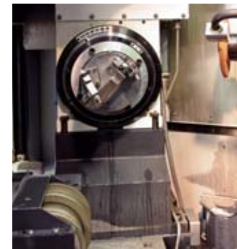
Der Bearbeitungsbereich des nach dem Viper-Verfahren arbeitenden Makino A55. Bei diesem Bearbeitungszentrum werden Räder unter Nutzung der tischmontierten Abrichtvorrichtung aussetzend endbearbeitet (unten links im Bild)
